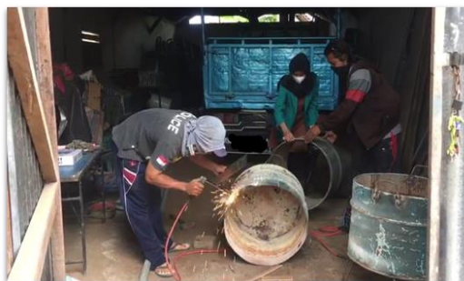
Gambar 2. Tahap pemotongan drum oli bekas dan pengelasan kaki tempat sampah
