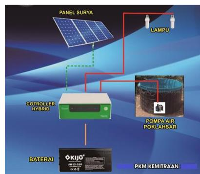
Gambar 5. Rangkaian instalasi LSA
