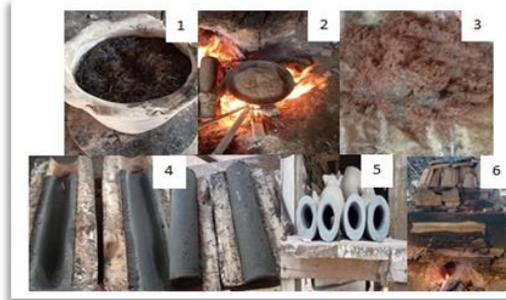
**Gambar 1.** Proses Pembuatan Membran Keramik
