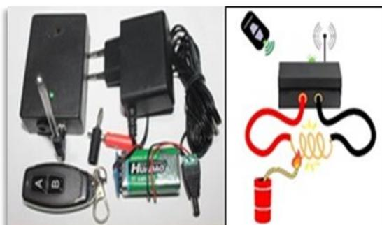
**Gambar 3.** Rangkaian kerja blasting machine
