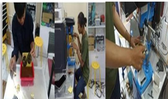
Gambar 4. Proses pelarutan dan pengeboran PCB sensor floc keju.
