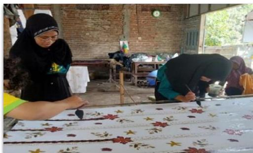
**Gambar 2.** Proses menutup dengan malan pada bagian yang tidak diwarnai
