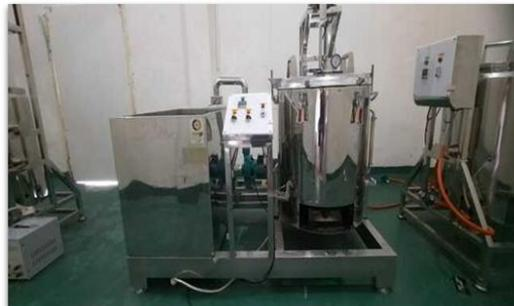
**Gambar 13.** Mesin evaporator vakum kapasitas 50 liter
