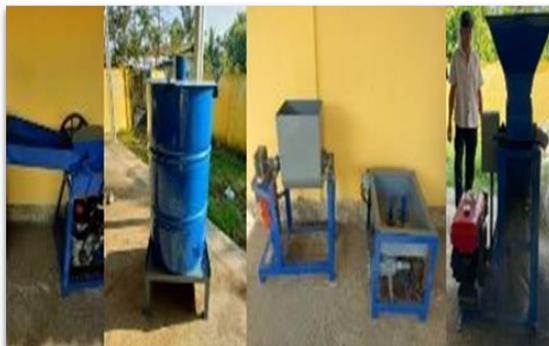
**Gambar 4.** Mesin pencacah untuk mengecilkan ukuran limbah sebelum diolah menjadi briket dan pupuk organic; Mesin pirolisis untuk pengarangan limbah; Mesin pengaduk adonan dan mesin pencetak briket; Mesin hammer mill
