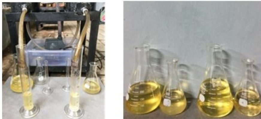
Gambar 2. Minyak (tar) hasil pirolisis sampah PP waktu 30 menit dan 60 menit
