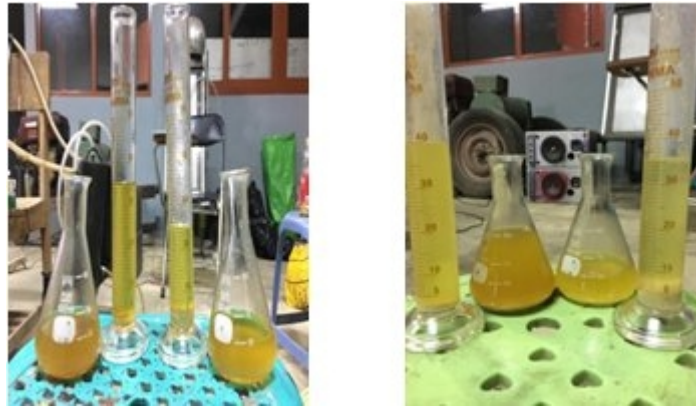
Gambar 3. Minyak (tar) hasil pirolisis sampah LDPE waktu 30 menit dan 60 menit
